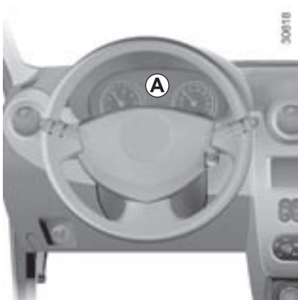
Сигнальные лампы на щитке приборов А
